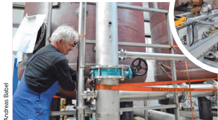
In einer der Hallen der Chriwa Group in Hambühren verschraubt Detlef Thiele eine Kiesfilteranlage. Die Biogasanlage wartet in der Versandhalle auf den Abtransport nach Phnom Penh (rundes Bild).
