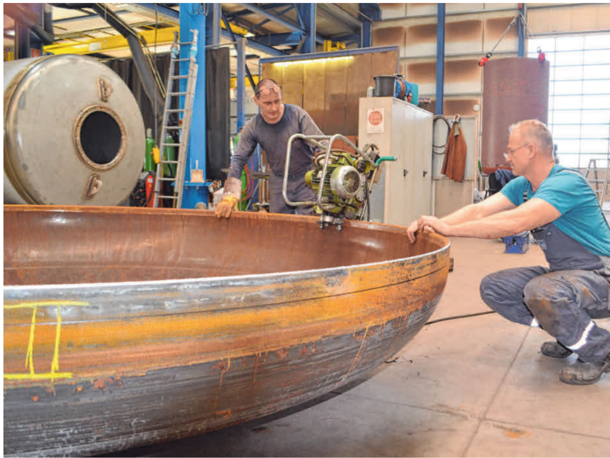
In der Fabrikationshalle der Chriwa Group in Hambühren bereiten Bruno Pejic (rechts) und Tomasz Soleta die Kappen von großen Tanks für Schweißarbeiten vor.
